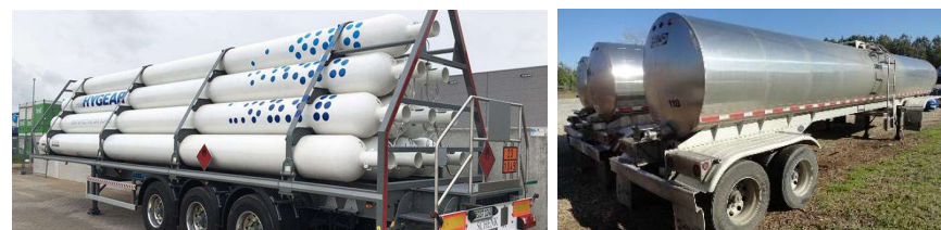
Figuur 4 Opslag in een tubetrailer of tankwagen
