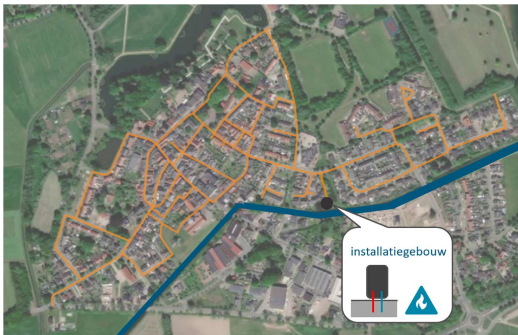
Figuur 7 Schets van systeem voor noorden van Bredevoort (scenario 3 & 4)
