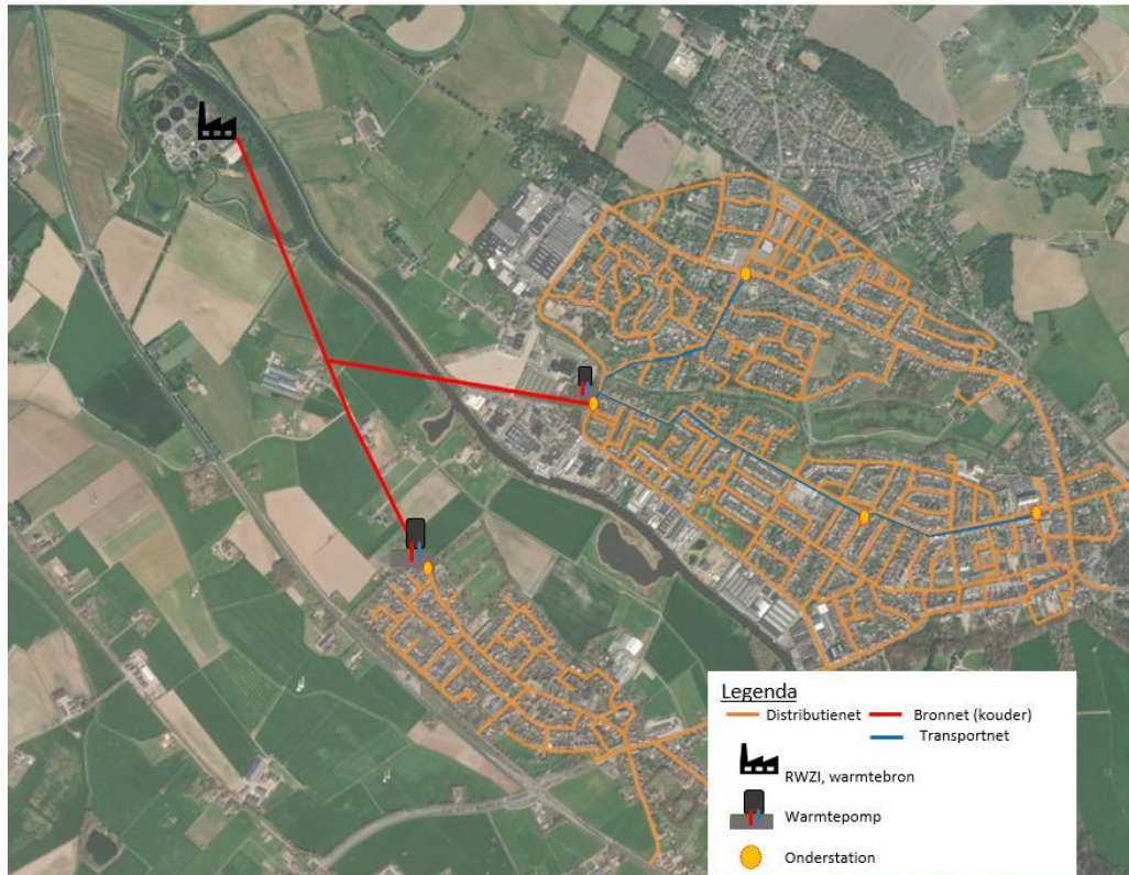
Figuur 13: Schets van een mogelijk netwerk voor scenario 3: Etten, Gaanderen en Terborg
