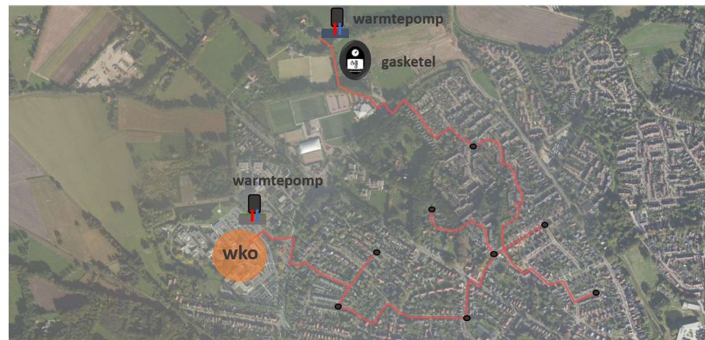
Figuur 5 Schematische weergave van het primaire leidingnetwerk, inclusief bronnen en verdeelstations
